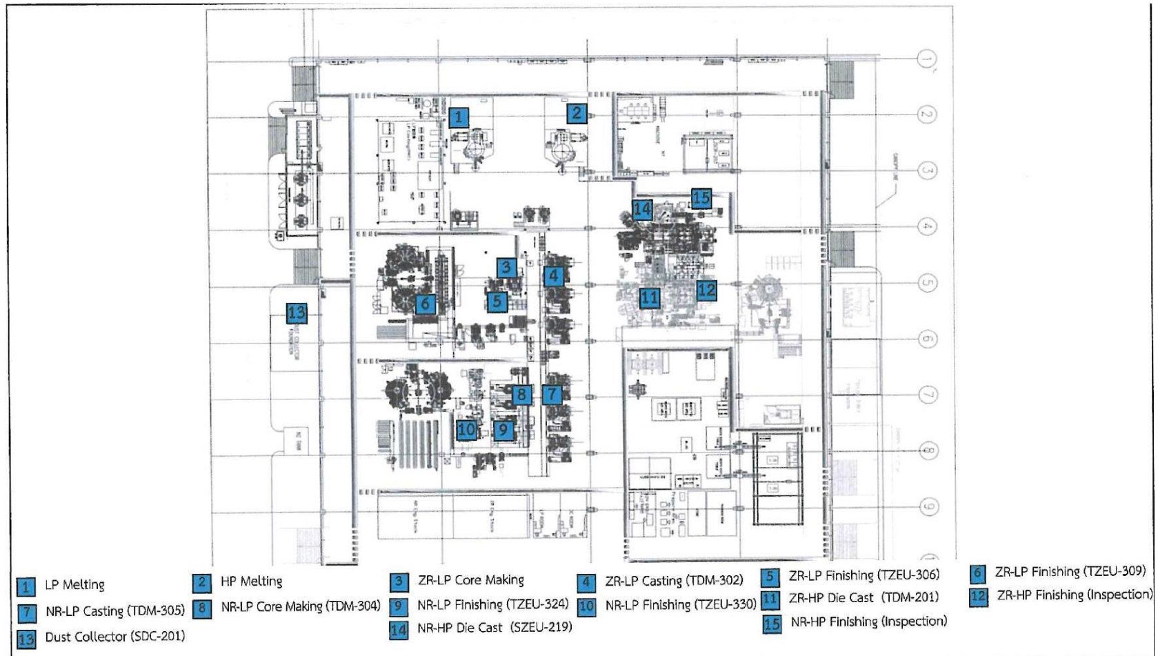
รูปที่ 3.4-24 ตำแหน่งตรวจวัดระดับเสียงในสถานประกอบการโรงงานผลิตชิ้นส่วนเครื่องยนต์แก๊สโซลีนจากอลูมิเนียม
